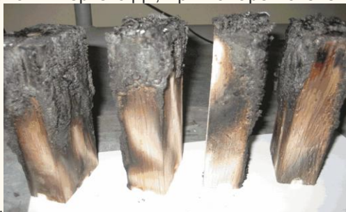
Рис.4. Вспененный слой огнезащитного покрытия «Нертекс-Д»
