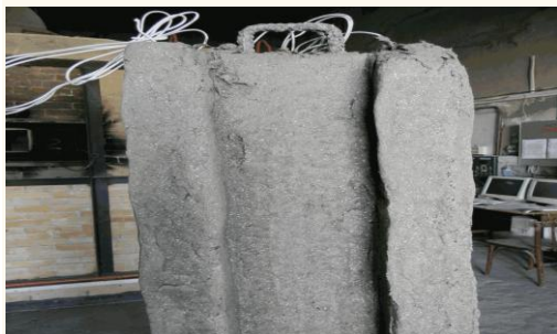
Рис.2. Металлическая конструкция с огнезащитным покрытием «Нертекс-У»
