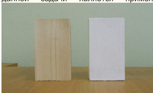
Рис.3. Древесина с огнезащитным покрытием «Нертекс-Д»
